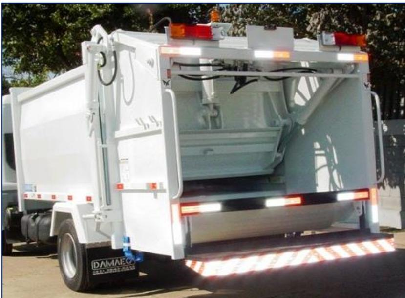
Coletor novo, de fabricação nacional, com capacidade para 6 e 8m<sup>3</sup>, teto em chapa lisa, laterais em chapa única calandrada, descarga por painel ejetor, com cilindro de dupla ação e sistema de carregamento traseiro, com compactação por sistema pendular, acionado por cilindro de compactação com diâmetro de 4.1/2”, e placa de transferência comandada também por dois cilindros com diâmetro de 3 1/2”, com comando semiautomático;
