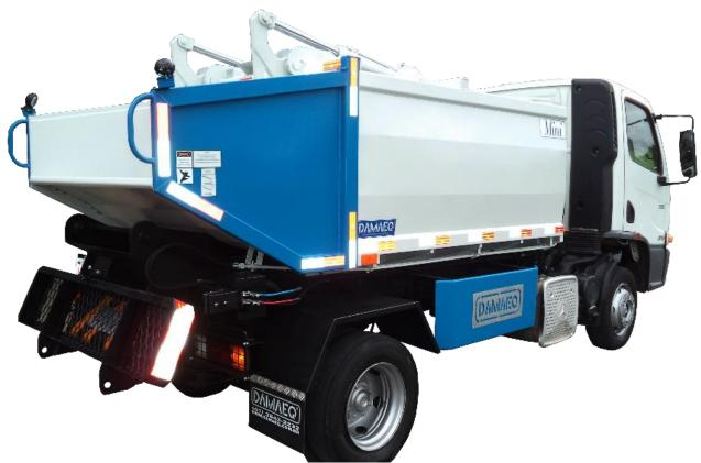
Coletor novo, de fabricação nacional, com capacidade para 4 m³ - 5m³, teto em chapa lisa, laterais em chapa única calandrada, descarga por basculamento da caixa coletora, com cilindros de dupla ação e sistema de carregamento traseiro, com compactação por placa pendular, acionada por cilindros de compactação com diâmetro de 2.1/2";
